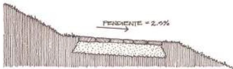
B- EN LADERAS SECCION
