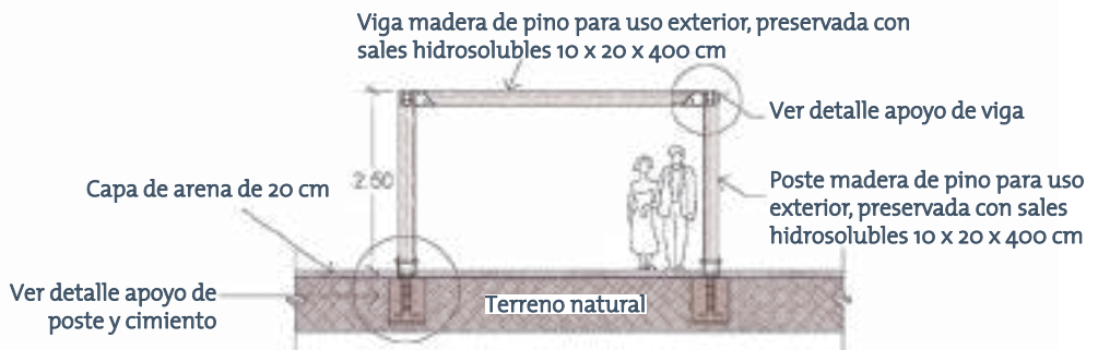
PÉRGOLA ENRAMADO SECCIÓN VER DETALLE PÉRGOLA TIPO
